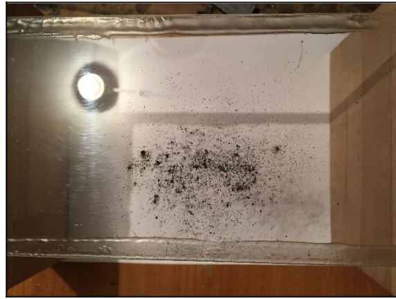
Abb. 8: Metallspäne auf Plexiglas-Scheibe
