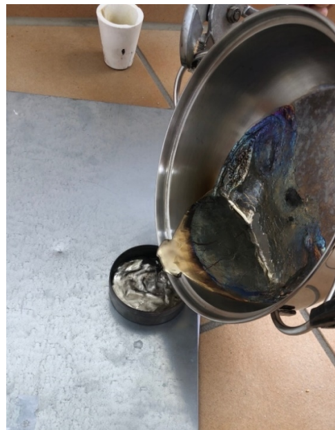
Abb. 29: Gießen des flüssigen Bismuts
