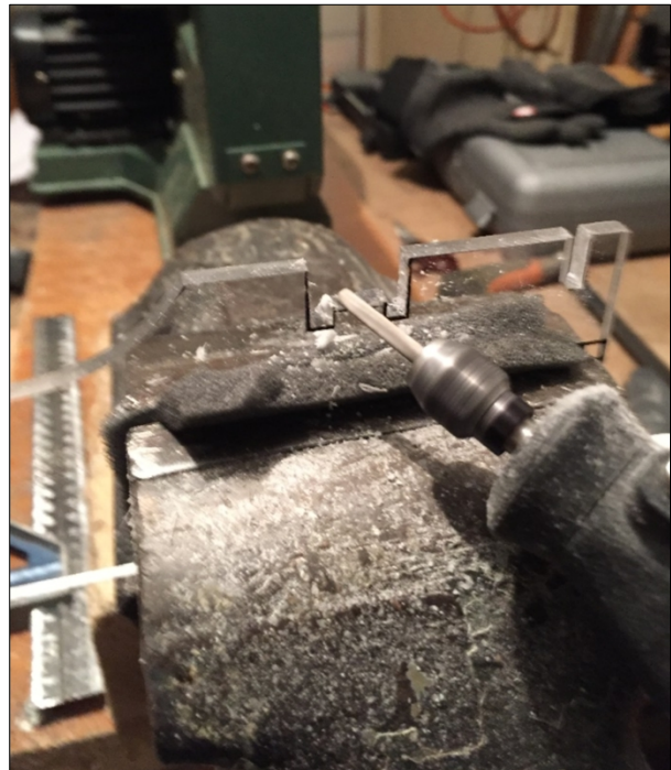
Abb. 64: Ausfräsen einer Nut für Bismutplatten
