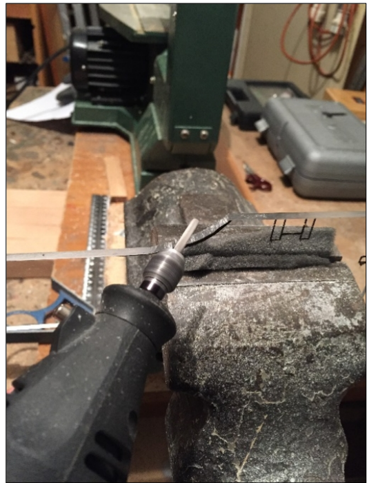
Abb. 62: Ausfräsen der runden Bereiche
