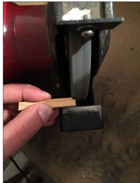
Abb. 33: Schleifen von Holzschienchen
