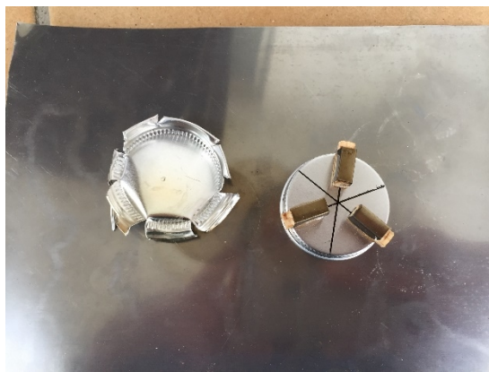
Abb. 43: benutzte Gussform mit Stempel
