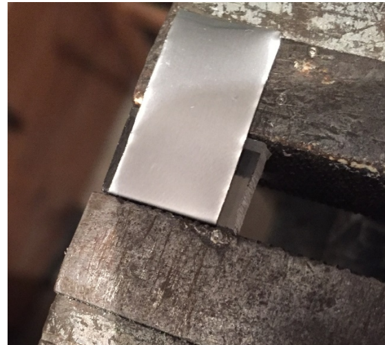
Abb. 37: Zurechtbiegen des Stahlblechs
