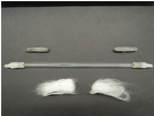
Abb. 17: Quarzrohr mit Glaswolle und Stahlwolle
